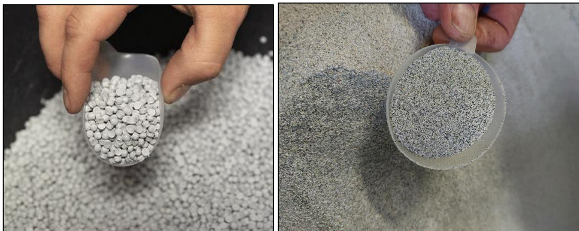
Figure 16 : PVC recyclé par régénération (à gauche) et micronisation (à droite) (@PAPREC)
