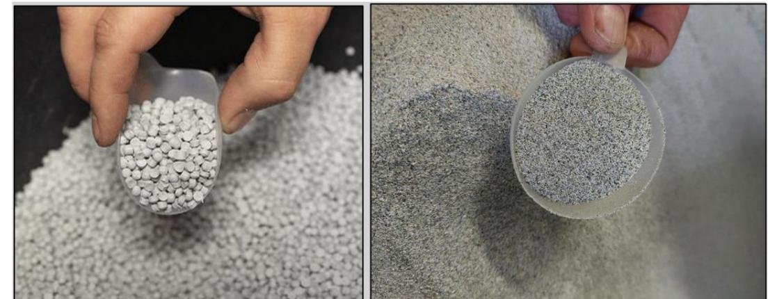
Figure 148 : PVC recyclé par régénération (à gauche) et micronisation (à droite) (©PAPREC)
