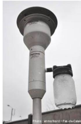
Figure 232 : Préleveur d'air (Source : ATMO Hauts-de-France)
