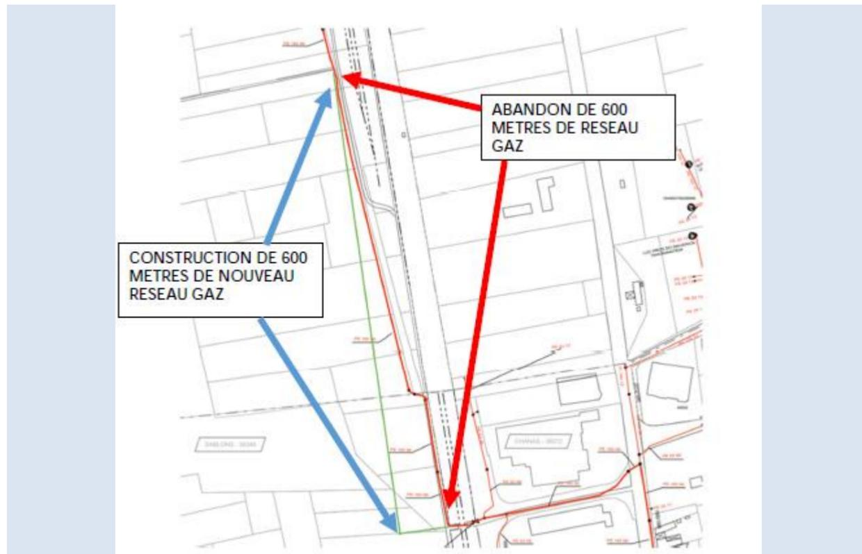
Figure 27 : Localisation du dévoiement du réseau de gaz GRDF
