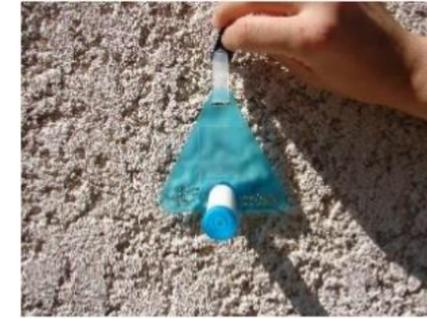
**Figure 230 : Tube à diffusion passive (Source : ATMO Auvergne-Rhône-Alpes)**
