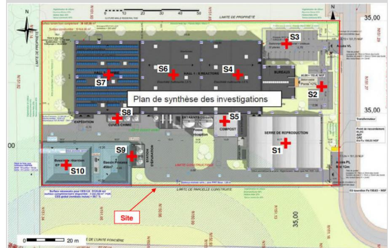
Figure 73 - Plan de localisation des sondages sur fond de plan d'aménagement au moment des sondages
