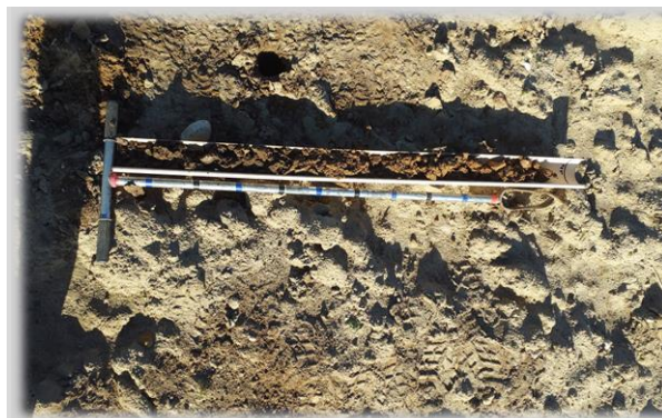
Photo 5 : Sol limono-sableux avec présence de remblais (tuile, goudrons, ...)
