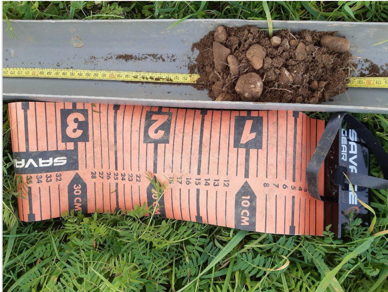
Figure 270 : Illustration d'un sondage montrant la présence de gravats et de cailloux sur la zone ouest
